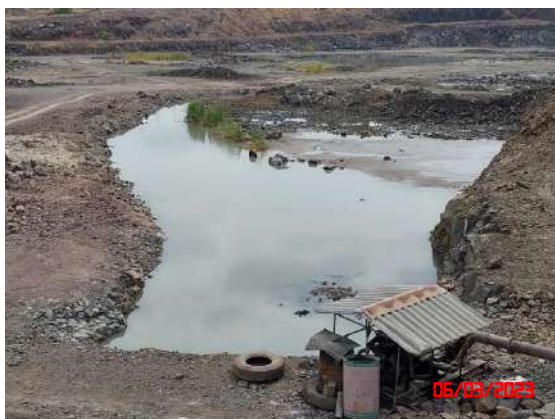
รูปที่ 9 บ่อรับน้ำ (Sump) ชุมเหมือง
